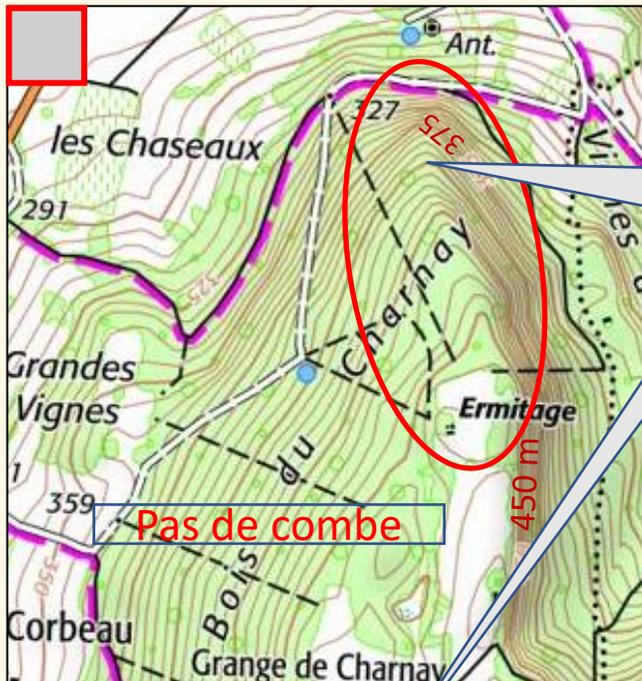
Le **V** des courbes de niveau est en direction de l'**aval**, donc il s'agit d'une **crête** et non pas d'une combe.
